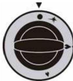
Fig. 11. Position du bouton en position "robinet gaz fermé"
