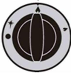
Fig. 9. Position du bouton pour une flamme maximale
