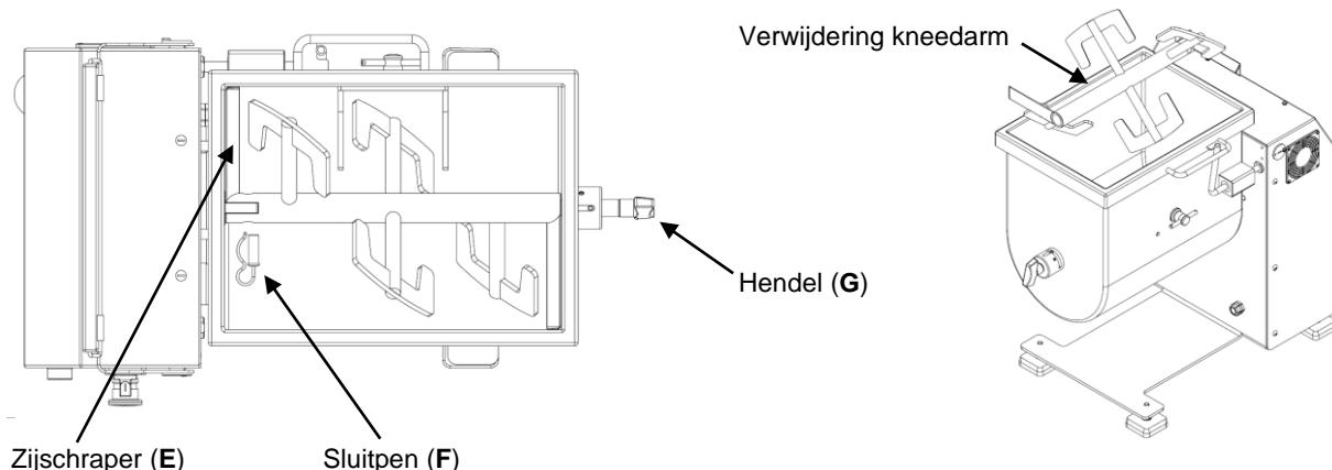
Op deze manier en met behulp van warm water, neutrale zeep en vochtige doeken is het makkelijk om de machine schoon te maken. Ook is het mogelijk om de bak en de bladen met een drukapparaat te reinigen. Daarbij moet erop gelet worden dat er geen directe druk wordt uitgeoefend op het gedeelte met de rechter- en linkeras, waar zich de keerringen bevinden.
