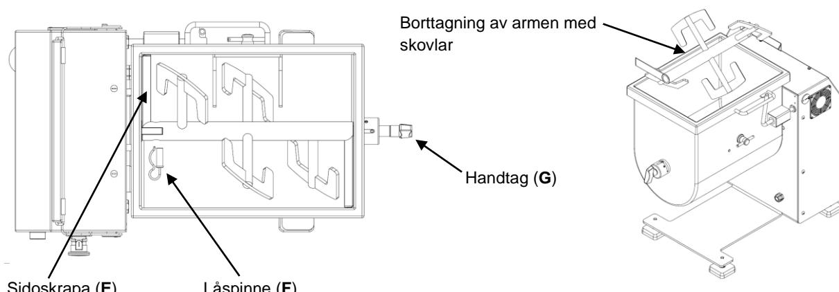
På så sätt och med hjälp av varmt vatten, neutral tvål och fuktiga trasor går rengöringen lätt. Det är också möjligt att rengöra kärlet och skovlarna med en tryckapparat, men man måste då se till att inte direkt behandla områdena vid höger och vänster axel där spärrarna sitter.
