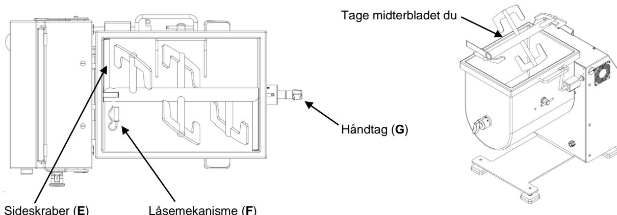
Rengøringen er således nem at udføre med varmt vand, et neutralt rengøringsmiddel og et par fugtige kulde. Beholderen og bladene kan også rengøres med et trykapparat, så længe man passer på ikke at ramme venstre- og højreejerne, hvor palerne sidder, direkte.
