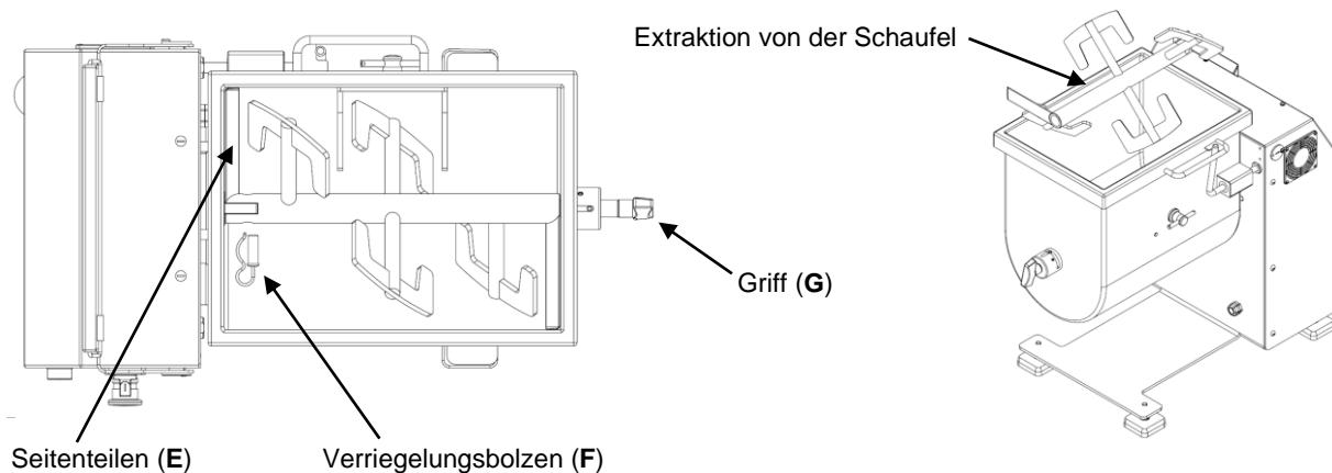
Nun lässt sich die Maschine mit warmem Wasser, einem neutralen Reinigungsmittel und feuchten Lappen einfach reinigen. Das Gefäß und die Schaufel können auch mit einem Druckreiniger gereinigt werden, wobei darauf zu achten ist, damit nicht direkt in die Bereiche der rechten und der linken Achse, wo sich die Verriegelungsvorrichtungen befinden, zu gelangen.
