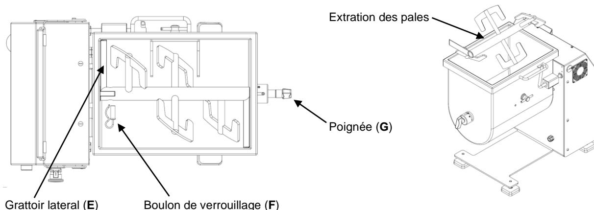
De cette façon, le nettoyage sera tâche facile avec de l'eau chaude, du savon neutre et des lignes humides. Il est possible de nettoyer le récipient et la pale avec un appareil de pression, mais, dans ce cas, prendre soin de ne pas toucher directement les zones des axes droit et gauche où se trouvent les joints.
