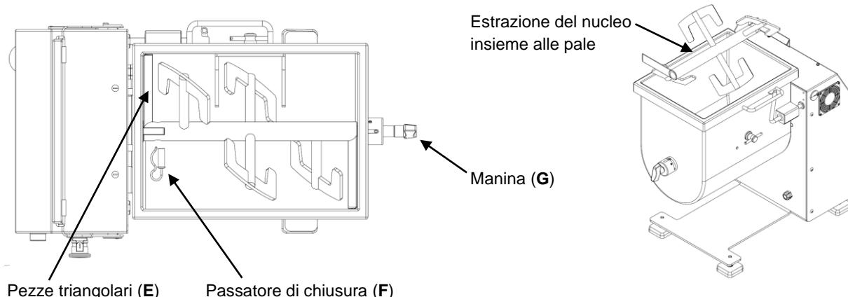
Di questo modo e anche con l'aiuto di acqua calda, sapone neutro e dei panni umidi, la pulizia sarà lavoro facile. Inoltre, è possibile pulire il recipiente e la pala con un apparecchio di pressione, procurando di non incidere direttamente nelle zone degli assi destro e sinistro, dove si trovano i ritensori.
